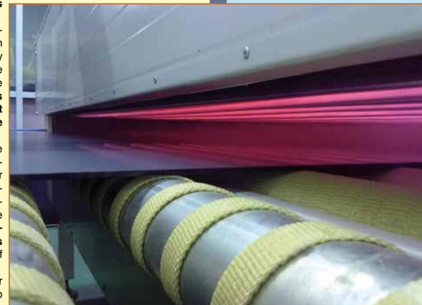
Le ridotte dimensioni del modulo sono possibili grazie all'equipaggiamento di GLASSDRIER-IR con lampade ad infrarosso. L'altezza delle lampade all'infrarosso e la lunghezza d'onda sono state determinate in modo da consentire la massima efficienza con il minor ingombro possibile, consentendo in questo modo un **elevato rendimento dello scambio termico ed un considerevole risparmio energetico**.
